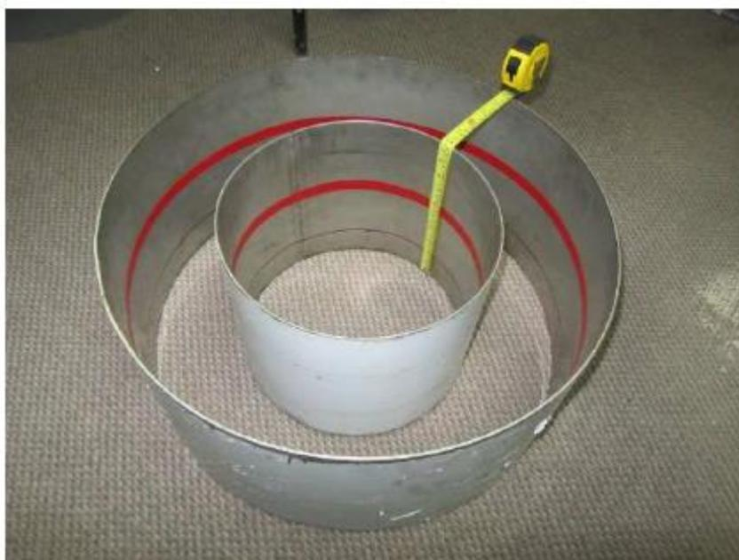
Figura 15-1. Propuesta de instalación de los anillos de infiltración.
