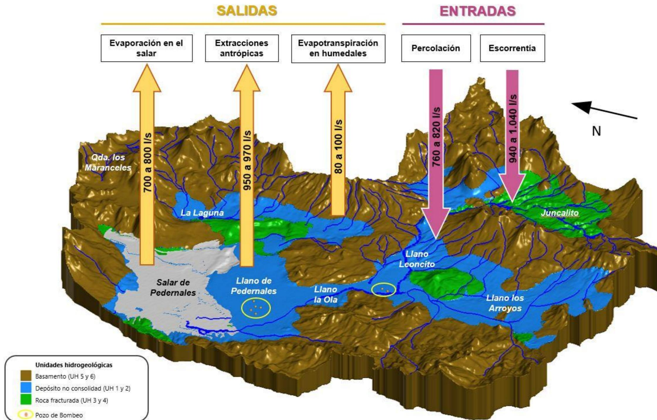
Figura 9-1. Vista esquemática 3D del balance hídrico cuenca Salar de Pedernales.
