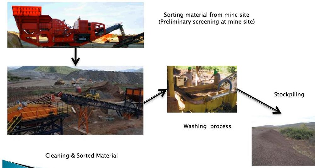
Figura 5.1: Ejemplo de extracción de mineral de manganeso (Fuente Maxtech Ventures en Palisade Research, 2017)
